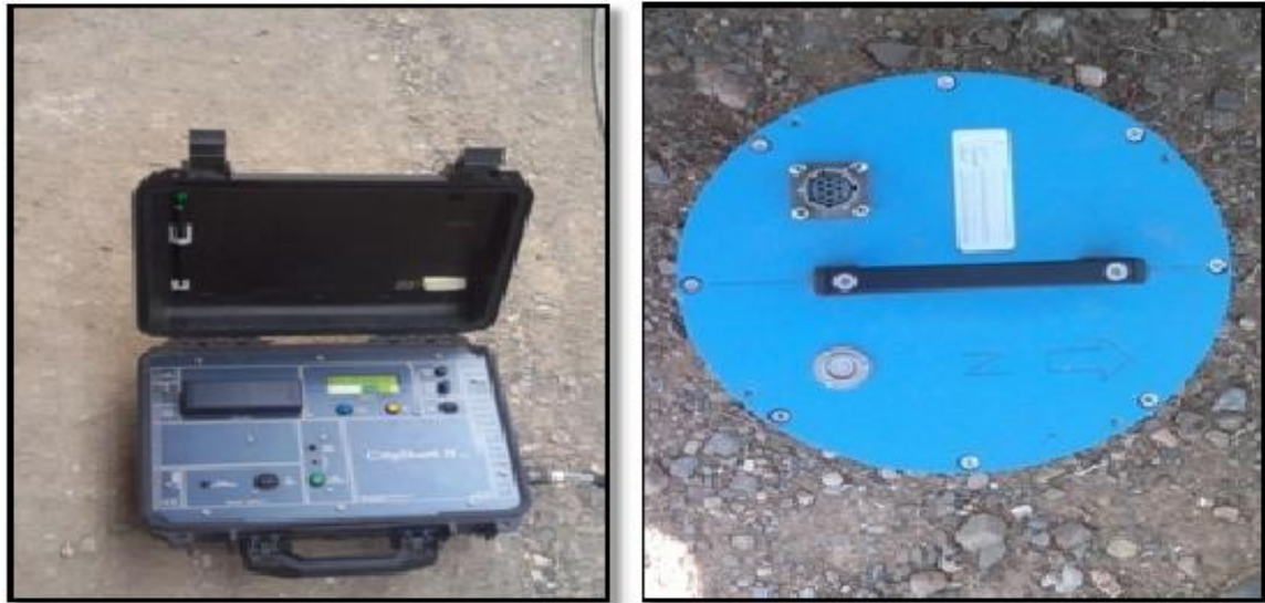
Figure 2: Type de matériel utilisé pour l'enregistrement du bruit de fond. Station d'enregistrement CityShark II (à gauche) et sismomètre Lennartz 5-secondes (à droite).
